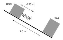
Der Klotz prallt unten auf eine Wand, wird zurückgeworfen, kommt wieder nach unten, usw. Im beiliegenden Diagramm sind die Position (dashed) und die Geschwindigkeit (solid) des Körpers dargestellt.
